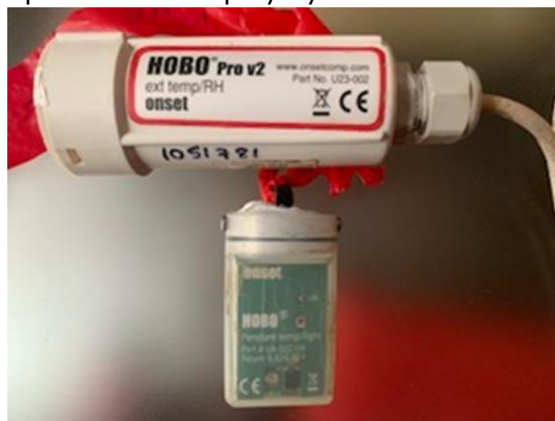
Figura 6. Dataloggers, el de arriba es Hobo Pro v2 y el de abajo Onset Hobo tipo Pendan.
